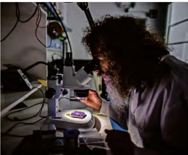
Hezi Tenenboim bestückt eine Mini-Gaskammer, in der die Sensoren getestet werden.
